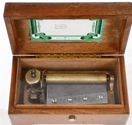
1405 Walzenspieluhr, Segmentspielwerk (Kämme sind einzeln verschraubt), um 1860, intakt, ohne Schlüssel, Kästchen in Schildpatt-Optik, L 9 cm, Rarität 220,- €
