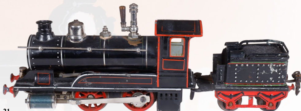
21 Märklin B-Dampflok 4000, mit 2A-Tender, Spur 0, spiritusbetrieben, uralt, HL, mit Armaturen, Pfeife, feststehenden Zylindern und Brenner, Alterungs- und Gebrauchsspuren, kleine LS und Brandspuren, noch Z 2 450,- €
