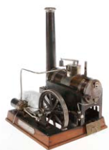
4129 Schoenner Dampfmaschine „Lipsia“, uralt, liegender patinierter Kessel, KD 7, mit Brenner, Armaturen (lose und tw NV), feststehendem Zylinder und Speisepumpe, auf Holzsockel, LS, L 25, zum Herrichten 150,- €
