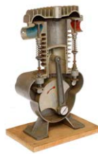
14374 Schnittmodell 4-Taktmotor zur Demonstration als Fahrschulmodell, Alu/Guss, H 40, Z 2-3 130,- €
