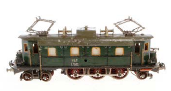
621 Schweizer 2-B-1 E-Lok „HLP“ E 1002, Spur 0, elektr., 3-Leiter, grün, wohl mit Märklin 66er Motor, je 2 el. bel. Stirn- lampen, LS und Alterungsspuren, Z 3 20,- €
