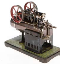
4139 Bing stat. Lokomobile, liegender patinierter Kessel, KD 8, mit Armaturen (NV), feststehendem Zylinder und Fliehkraftregler, Schlot und Brenner fehlen, auf Holzsockel, mit Blechfliesenboden, LS, L 29,5, zum Herrichten
