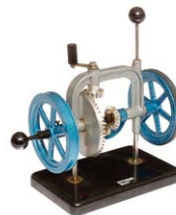
14346 HEMA Lehrmodell eines Autodifferentials, Alu/Guss, auf Bakelit, L 20, Z 2
