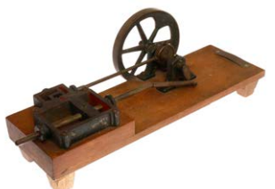
14326 M. PRINS, Instrumentenfabrik Utrecht, Lehr, Schnittmodell, Dampfzylinder mit Schwungrad auf Holzsockel, L 30, Z 2
