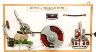
14365 Lehrmodell Hydraulische Bremse, mit Handbremse, im Wandkasten, mit elektrischer Funktion, intakt, Alterungsspuren, L 84, Z 2 250,- €
