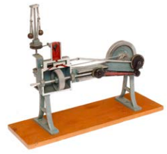
14335 Schnittmodell eines liegenden Dampfzylinders, mit Schwungrad und Regler, Alu/Guss, handlackiert, auf Holzsockel, L 38, Z 2-3
