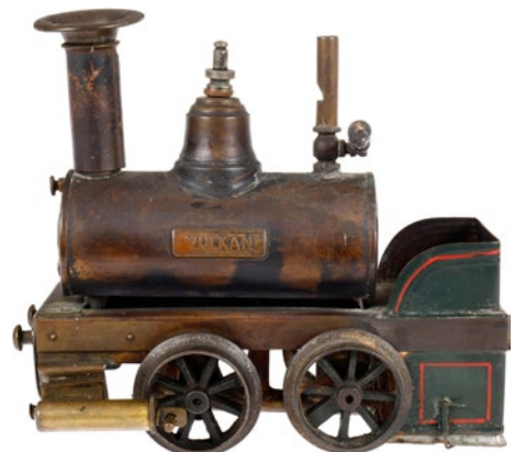
1072 Plank Dampflokomotive „Vulkan“, Spurweite 65, uralt, spiritusbetrieben, mit Brenner, Pfeife und 2 oszill. Zylindern, tw rest. und ergänzt, Z 3 100,- €
